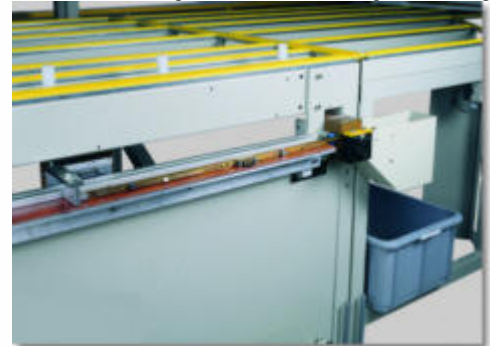
Beschlagstanze mit Stanzlängenanschlag
